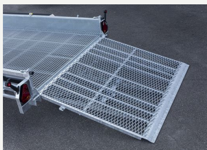
02 RAMPES DE CHARGEMENT ABAISSÉES
