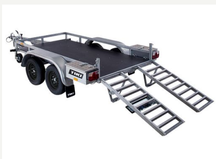
02 RAMPES DE CHARGEMENT ABAISSÉES
