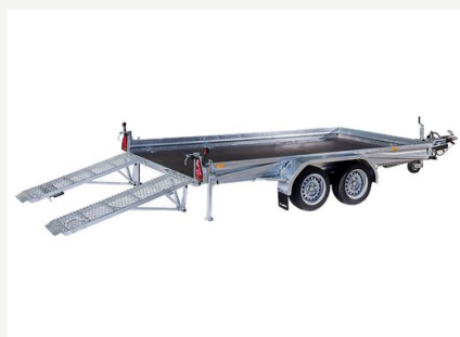
03 RAMPES DE CHARGEMENT ABAISSÉES
